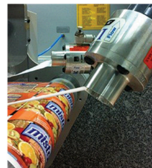
Line-Vac de 1" remueve y descarta la matriz de un etiquetado.
