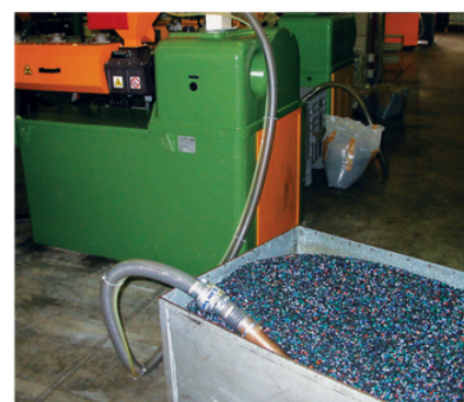
Un Line-Vac de 1-1/2" (38mm) modelo 6083 transporta granulado plástico a una tolva de alimentación por gravedad a un extrusor.
