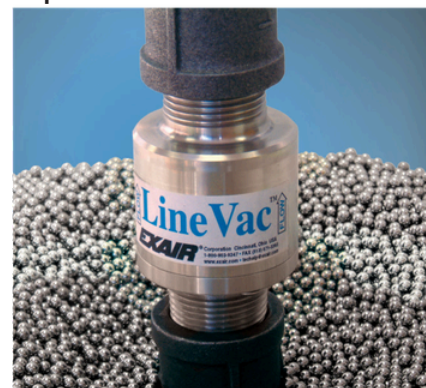
Un fabricante de guías de cajones transporta bolillas de rodamientos con el Line-Vac Roscado de 1-1/4 NPT de acero inoxidable modelo 141125 a una estación de montaje.
