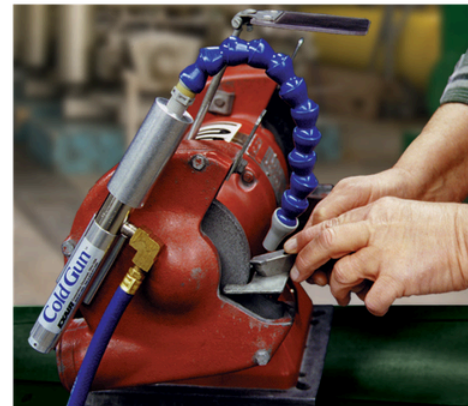
El aire frío elimina el agrietamiento por calor de la herramienta de carburo durante el afilado.
