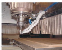
El aire frío de la Cold Gun modelo 5315 de EXAIR mantiene la herramienta refrigerada.
