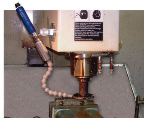
El Refrigerador Ajustable Dirigido reemplaza el refrigerante líquido y elimina horas de limpieza en una operación de mecanizado de hierro fundido.
