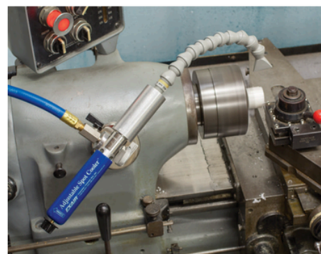
El Refrigerador ajustable dirigido mantiene tolerancias críticas en mecanización de partes plásticas.
