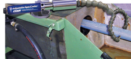
Manguera de PVC es enfriada a la salida de un extrusor para que pueda ser enrollada inmediatamente.
