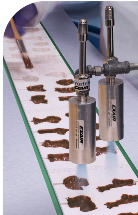
Dos Tubos Vortex enfrían rápidamente chocolate con leche en una línea de producción.
