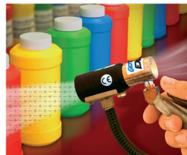
La pistola de Aire Ionizado Gen4 modelo 8293 neutraliza y limpia botellas plásticas previo al etiquetado.
