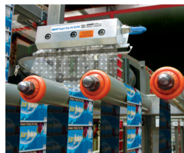
La Súper Cortina de Aire Ionizado Gen4 elimina la carga estática en las etiquetas que se aplican a botellas de PET para gaseosas.
