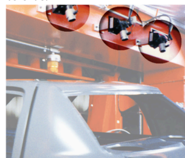
Tres (3) Cañones de Aire Ionizado Gen4 soplan los contaminantes de las carrocerías de los autos previos al proceso de pintura.
