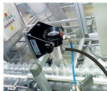
El cañón de aire Ionizado Gen4 modelo 8292 elimina la estática y el polvo previo a proceso de llenado de botellas.
