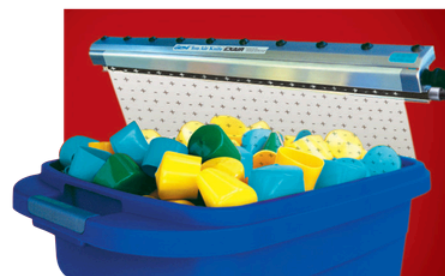
El sistema de la Cortina de Aire Ionizado Estándar Gen4 modelo 8218 18" (457mm) "baña" partes con iones eliminadores de estática para prevenir shocks para el personal.
