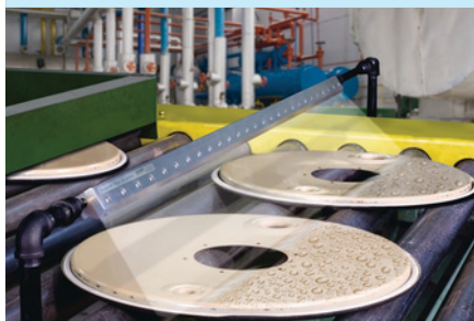
Súper Cortina Longitudinal de 54" (1372mm) modelo 110054 seca partes estampadas luego de salir de un lavado.
