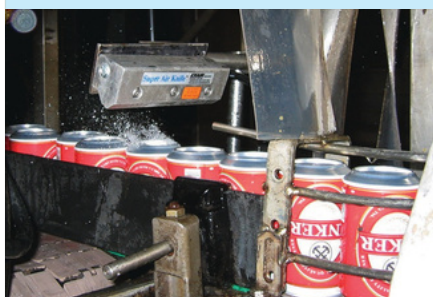
La Súper Cortina Longitudinal de 6" (152mm) modelo 110006 elimina agua residual de la parte inferior de latas luego del proceso de enjuague, evitando daños por humedad en los materiales de embalaje y envío.
