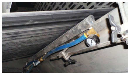
Una Súper Cortina Longitudinal de 48" (1219mm) con Kit de Conexión modelo 110048PKI utiliza el Sistema de Montaje Universal para mantener la posición adecuada para remover polvo sobre una cinta transportadora y eliminar la acumulación por arrastre.
