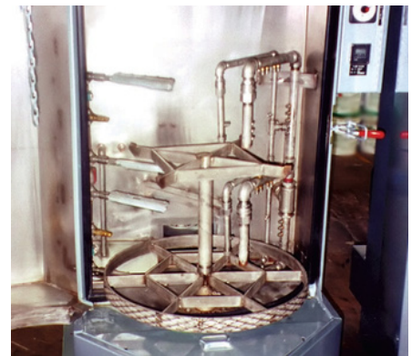
Tres Cortinas Longitudinales Estándar de 12" (305mm) modelo 2012 realizan el ciclo de secado en este lavado de partes.
