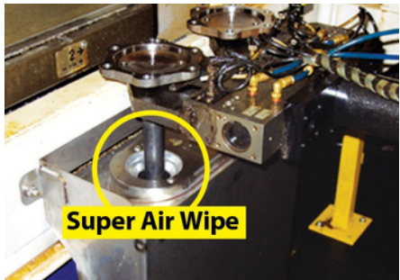
El extremo con brida de un eje se eleva a través de un Súper Cortina Circular para eliminar por soplado las virutas después del mecanizado.
