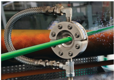
Una Super Cortina Circular de 1/2" de EXAIR seca un cable a medida que abandona su baño de refrigerado.
