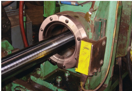
Una Súper Cortina Circular de 4" (102mm) modelo 2404 limpia una barra de acero luego de ser procesada.
