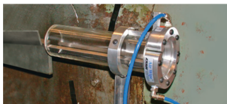
La Cortina Circular Estándar sopla el refrigerante de la pieza y lo devuelve a la rectificadora.
