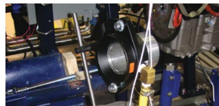
Un Súper Amplificador de Aire de 4" (102mm) modelo 120024 enfría un motor durante una prueba con dinamómetro.
