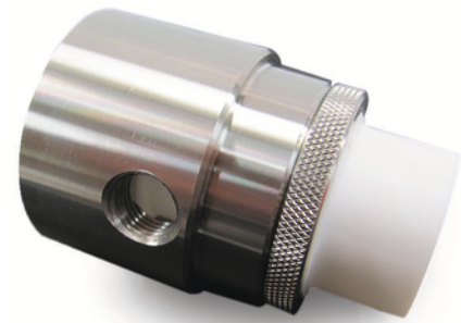
Este Amplificador de Aire de acero inoxidable con montaje por brida, de diseño especial, fue concebido para extraer gases de combustión calientes de un horno.
