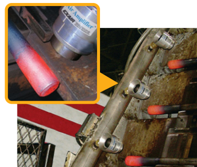
Amplificador Ajustable de 2" (51mm) modelo 6042 con los Acoples Giratorios enfrían ejes calentados por inducción antes de instalar las masas.
