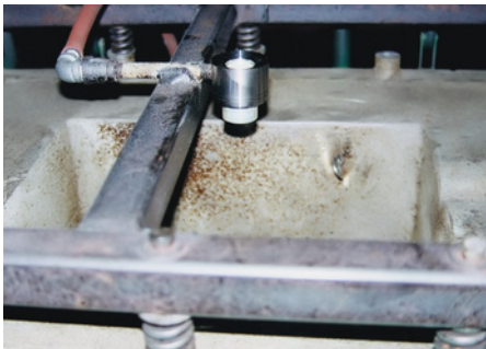
Un Amplificador de Caudal para Altas Temperaturas de 1-1/4" (32mm) modelo 121021 dirige aire caliente hacia la cavidad del molde rotacional para lograr un espesor de pared uniforme en la pieza plástica.
