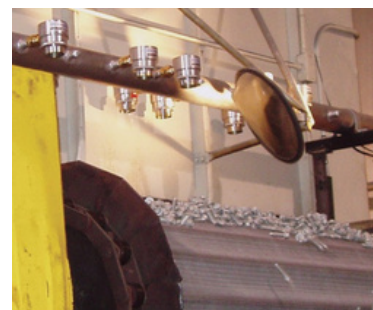
Partes metálicas son secadas utilizando una serie de Amplificadores Ajustables de 2" (51mm) modelo 6042.
