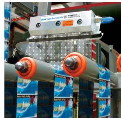
¡La Súper Cuchilla de Aire Ionizado Gen4 elimina la carga estática en las etiquetas que se aplican a botellas de PET para bebidas gaseosas.
