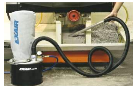
El Chip Vac Mini posee el mismo poder de limpieza que el Chip Vac y su tamaño lo vuelve ideal para trabajos pequeños
