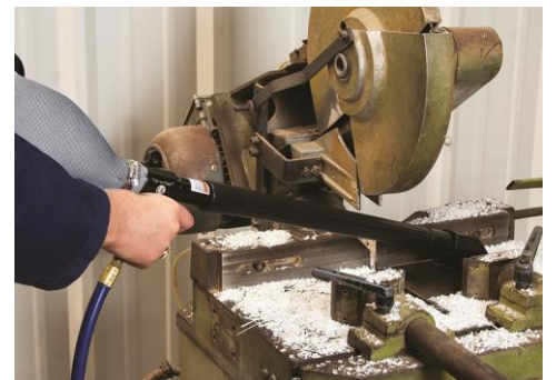
El sistema multipropósito Vac-u-Gun modelo 6393 retira residuos plásticos de una sierra.
