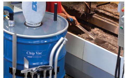
El Chip Vac de 110 galones ofrece capacidad máxima de limpieza en una operación de mecanizado.
