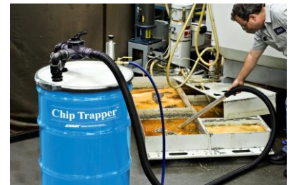
El Chip Trapper aspira refrigerante sucio y virutas hacia el tambor.
