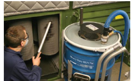
Un sistema de filtrado obstruido de una cabina de pulido se limpia rápidamente y se vuelve a poner en servicio usando el Heavy Duty HEPA Vac.
