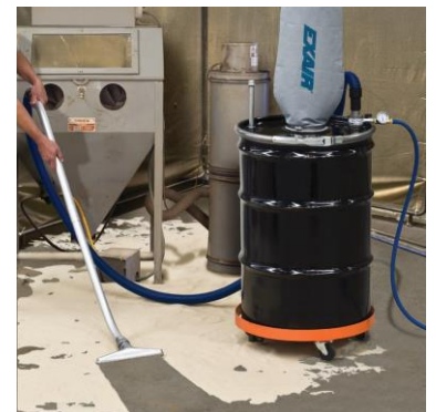
Arena en el suelo cerca de una arenadora es aspirada rápidamente al tambor con la herramienta robusta para suelos.
