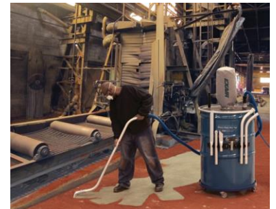
El Heavy Duty Dry Vac de 110 galones ofrece la máxima capacidad de limpieza para una aplicación de gran volumen y polvo intenso de cáscaras de nuez.
