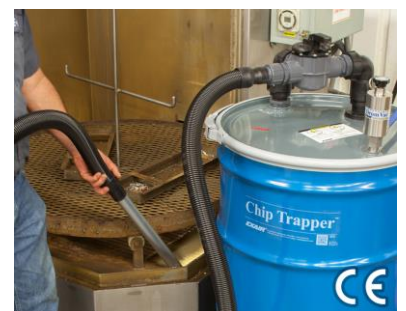
El Chip Trapper filtra los sólidos fuera del líquido utilizado para limpiar componentes.
