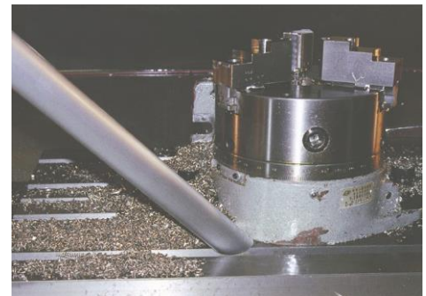
El Chip Vac remueve virutas abrasivas de acero inoxidable de un CNC.
