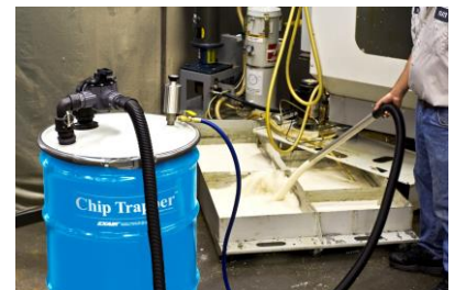
El Chip Trapper bombea el refrigerante nuevamente hacia la bandeja: libre de virutas y residuos.
