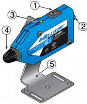
Después de conectar la fuente de alimentación de 24V, active el interruptor de encendido (1) y abra la válvula de aire comprimido para alimentar el accesorio de conexión de 6mm (2) e impulsa los iones que equilibran las cargas y el flujo de aire simultáneamente.
