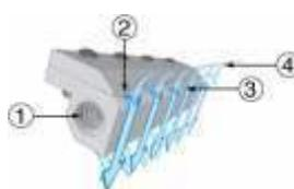
El Aire Comprimido ingresa a través de la entrada (1) hacia una cámara de distribución. El caudal es direccionado hacia el orificio ranurado (2). El flujo del aire primario se adhiere al perfil de la Cortina (3) y por efecto Coanda (a 90°) lo dirige hacia la parte inferior de ésta. Este flujo primario arrastra el aire del entorno (4) amplificando el caudal total para un incremento de 30:1.
