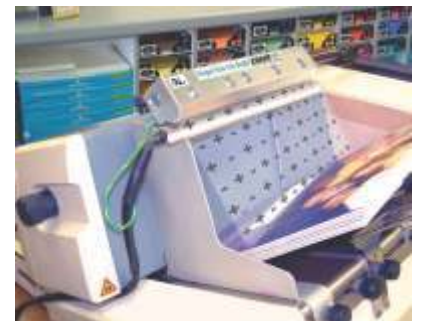
La Super Cuchilla de Aire Ionizadora elimina la interferencia mientras que mejora la calidad de la impresión en una máquina de chorro a tinta.
