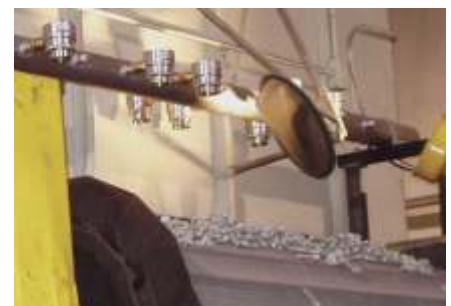
Partes metálicas son secadas utilizando una serie de Amplificadores de Aire Ajustables
