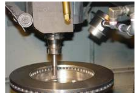
Un Súper Amplificador sopla virutas después de un proceso de mecanizado
