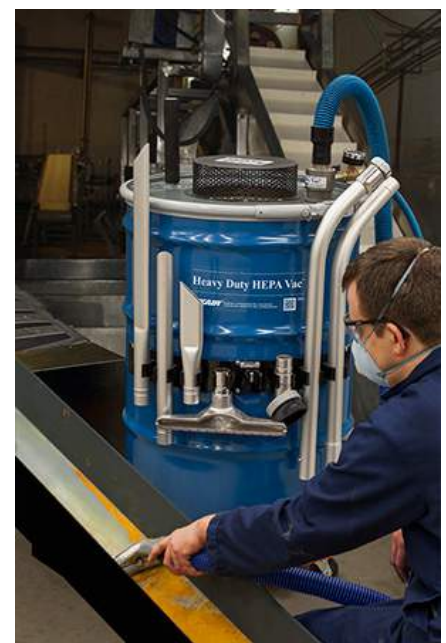
El Heavy Duty HEPA Vac es utilizado para realizar el mantenimiento programado en un pulverizador.
